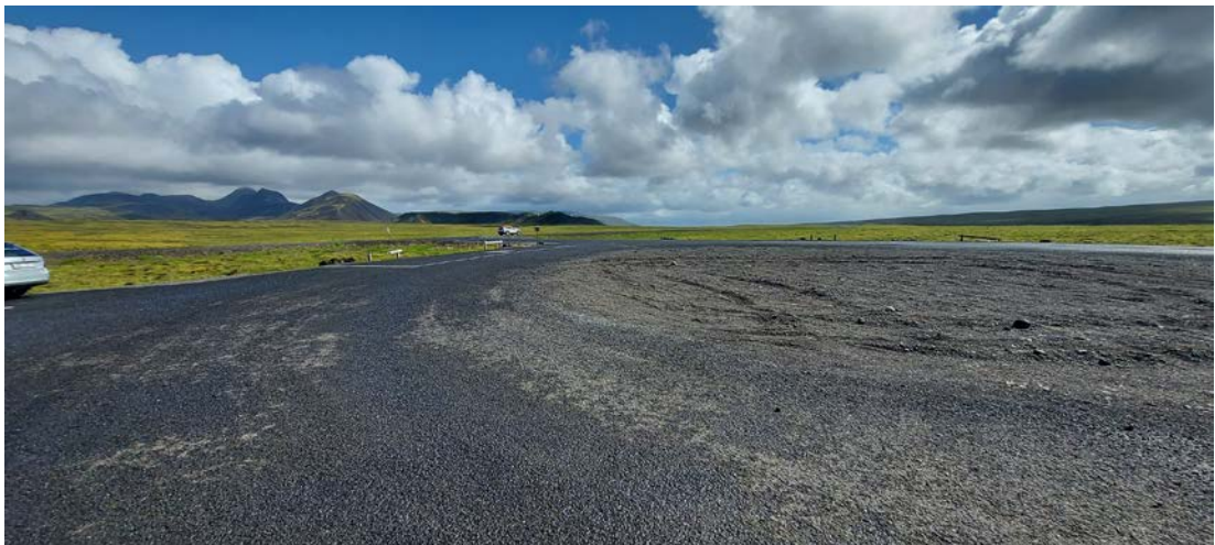
Mynd 4.17 Dæld í miðju áningarstaðar getur veist snjóruðningstækjum erfið.
